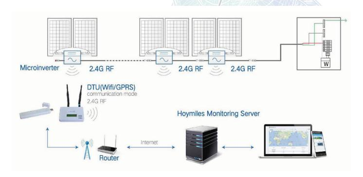
Merkmale von Photovoltaik-Anlagen mit Mikrowellen-Wechselrichtern im Vergleich zu Photovoltaik-Anlagen mit String-Wechselrichtern
